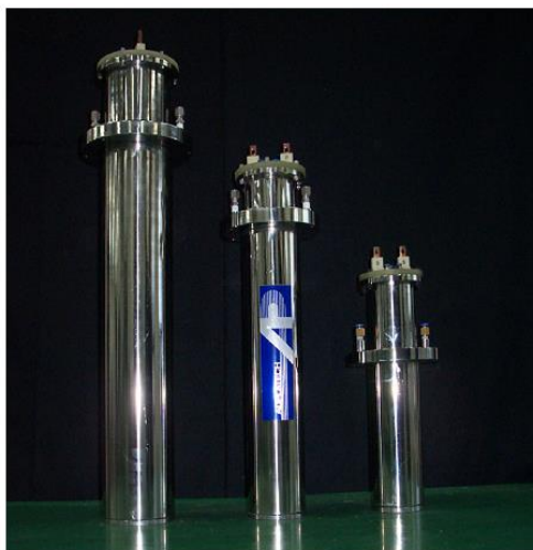
Figura 16 - Imagens de tochas de plasma fabricadas pela GS Platech (à esquerda) e vista interior de maçarico de plasma (direita) instalado no forno integrado.
