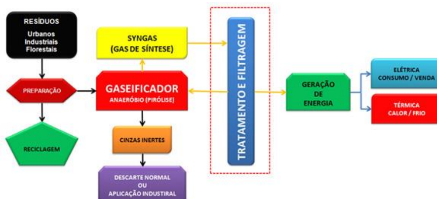
Figura 5 - Fluxograma do processo de gaseificação Fonte: ERBR, [201-].
